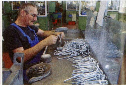
Hier werden die Muttern poliert. Für ihre Herstellung werden vorher einfach Mehrkantrohre aus Inox-Stahl geschnitten, mit einem Gewinde versehen und geschliffen.
