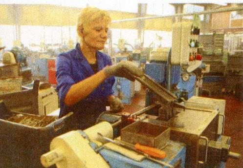
◀ Nachdem die Inox-Stangen gestaucht wurden (mehr dazu auf der nächsten Seite), wird in dieser Maschine das Gewinde in beide Enden geschnitten ...
